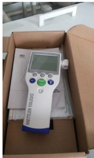
图 6-10 项目氟化物测定仪
